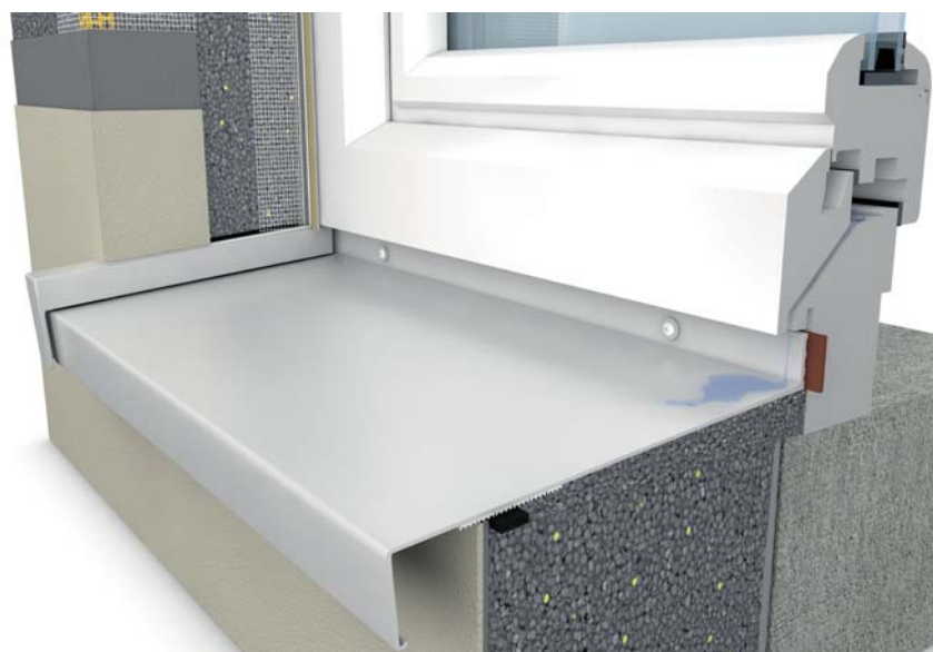
Die Abbildung zeigt die optimale Einbausituation einer Sto-Fensterbank mit einem Fensterrahmen mit verdeckter Entwässerung.
