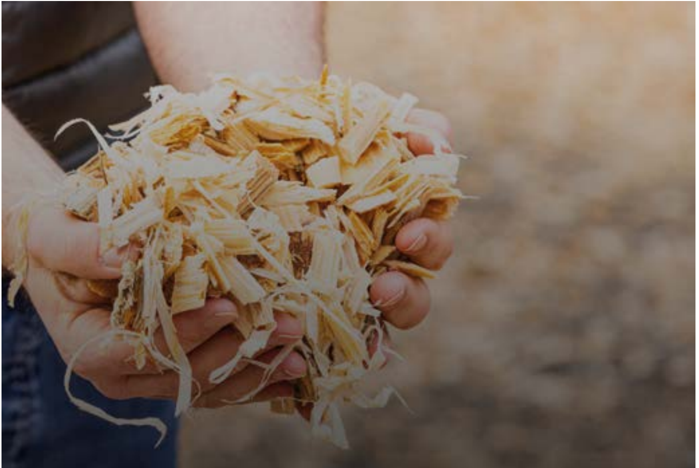
Rohstoff für den CO 2 -negativen Dämmstoff Holzweichfaser: Reststoffe aus der Holzverarbeitung
