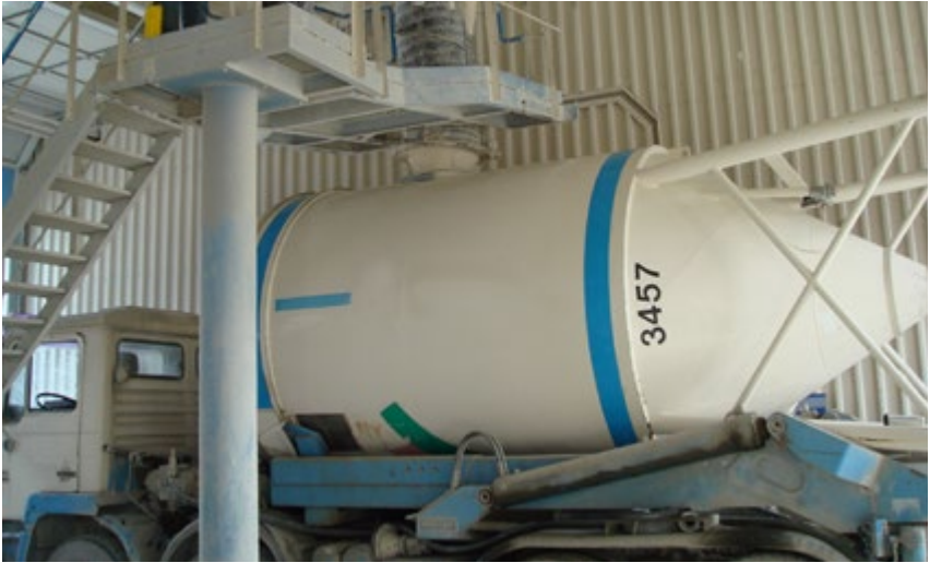
Abb. 1 Ortsfeste Beladestelle transportabler Silos
