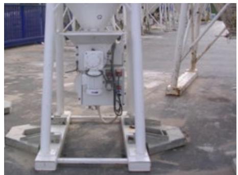
Abb. 4 Verbreiterung der Aufstandsflächen zur Erhöhung der Standsicherheit
