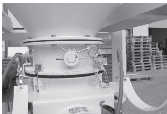
Links: Sicherheitsbolzen am Silo.
