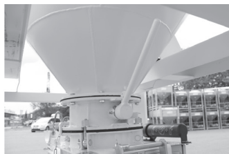
Rechts: Hebel zum Öffnen der Siloauslaufklappe
