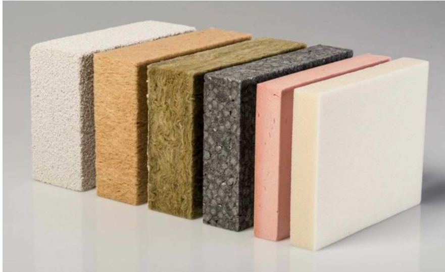
Unsere leistungsstarken Dämmstoffe, von links nach rechts: Mineralschaum, Holzfaser, Mineralwolle, Polystyrol-Hartschaum (EPS), Phenolharz-Hartschaum, PIR-Hartschaum
